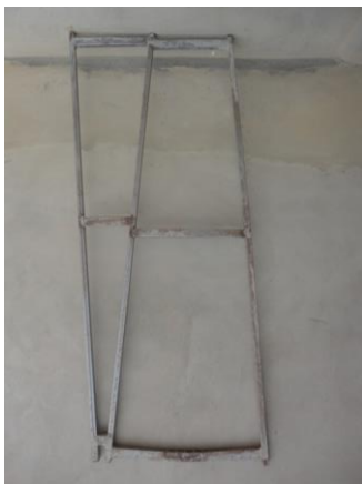
Figura 7: Fôrma das 4 diferentes placas da cobertura da cisterna
