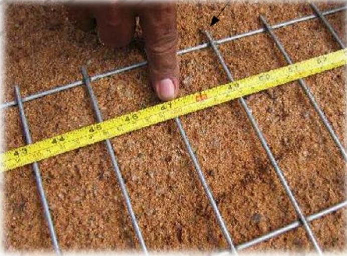
Malha de 5 x 15 com, arame de 3 mm de diâmetro e resistência a ruptura de 65/70 kgf/mm<sup>2</sup>
