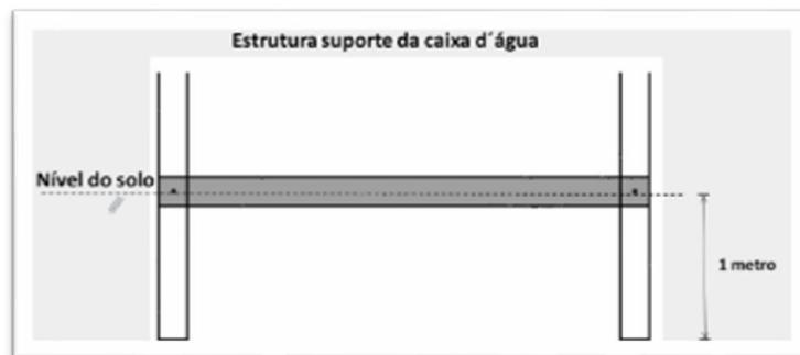
Vale destacar que a estrutura deve ser parafusada nos pilares a fim de garantir a sustentação da força exercida pelo peso da caixa d'água, conforme ilustrado na figura 8.
